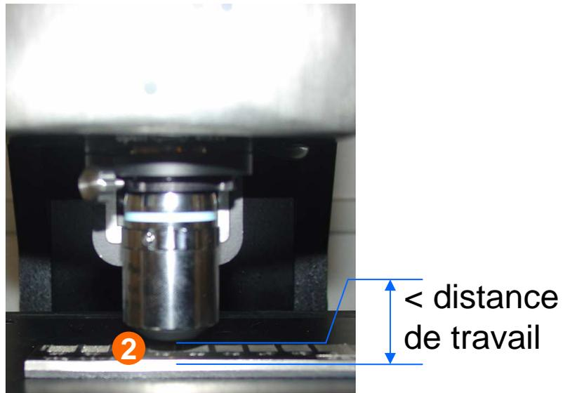
**2** – Descendre l'objectif à une distance de l'objet inférieure à la distance de travail de l'objectif. Utiliser la manette z .
