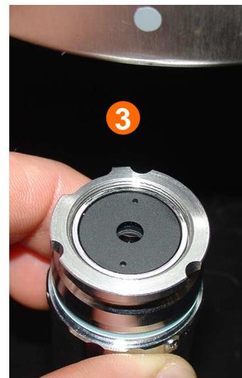
**4** – Placer l'objectif dans l'orifice en le maintenant plaquer vers le haut et tourner vers la droite
